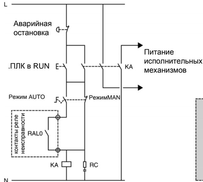
KA: контакт под управлением реле неисправности модуля питания в автоматическом режиме работы AUTO.
