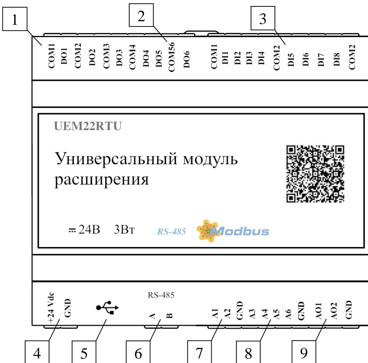
Модуль расширения выполнен в корпусе 6DIN на рельс 35 мм (DIN-рейку).
