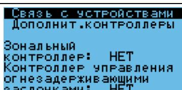
На этой странице мастера содержатся конфигурационные параметры, каждый из которых конфигурирует управление отдельным компонентом вентустановки. С помощью этих параметров задается основная конфигурация системы управления.
