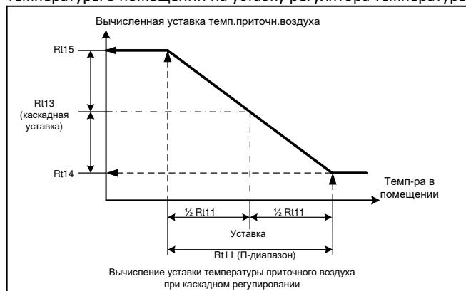
Rt13. Воздействие на уставку температуры приточного воздуха показано на рисунке: при снижении комнатной температуры уставка температуры приточного воздуха повышается, при повышении комнатной температуры уставка температуры приточного воздуха понижается. Изменение происходит относительно каскадной установки в зоне, ограниченной абсолютными значениями, задаваемыми с помощью параметров Rt14 и Rt15.
