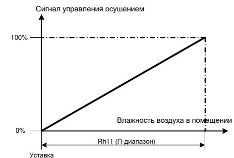
ПИ-регулятор влажности для режима осушения формирует управляющий сигнал, который используется для управления охладителем. Нагрев воздуха до требуемой температуры производится на нагревателе, устанавливаемом после охладителя, а работа основного нагревателя запрещена (кроме случаев, когда используется предварительный подогрев воздуха перед осушением). В режиме осушения сезонная блокировка нагрева игнорируется.
