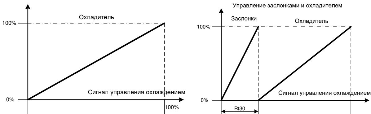
Сигнал управления охладителем блокируется при снижении наружной температуры до значения параметра Rt04 (если используется датчик наружной температуры) и, если при активном ручном переключении ЗИМА / ЛЕТО выбран режим ЗИМА. Управление заслонками блокировка не затрагивает.
