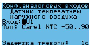
Теперь может быть выбран номер входа для выбранного датчика. Для выбора доступны только свободные входы или отказ от использования датчика (значение **Не используется**). Подтверждение введенного значения и перемещение курсора на поле выбора типа датчика производится при нажатии на кнопку .
