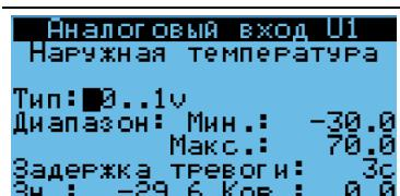
Если выбран активный датчик с выходным сигналом 0..1в, 4..20mA, и т.п., становится доступным для изменения диапазон измерений датчика.
