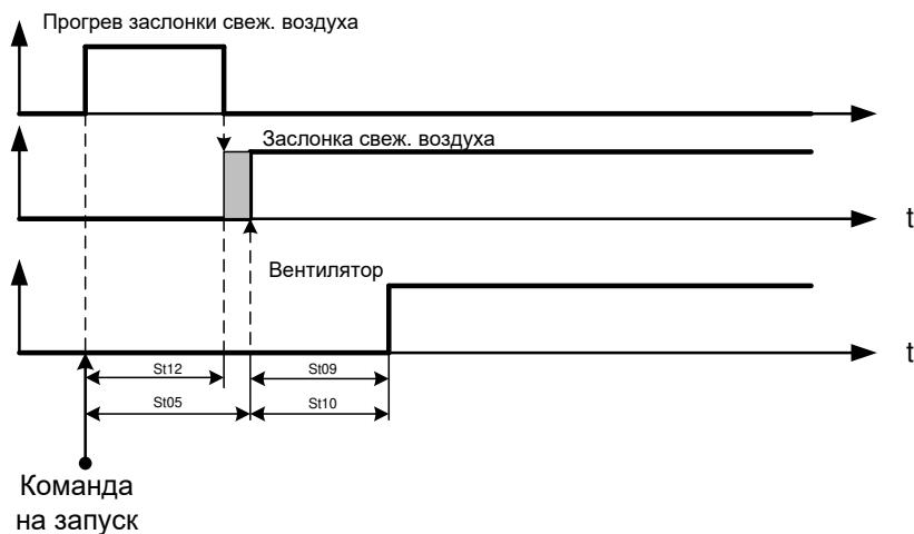
После получения команды на запуск, и истечения времени задержки, заданного параметром St05, начинается открытие воздушной заслонки. После подачи команды на открытие заслонки начинается отсчет времени задержки приточного и вытяжного (если используется) вентиляторов. Время задержки задано параметрами St09 и St10 соответственно. Если управление воздушной заслонкой не используется, то отсчет времени задержек St09 и St10 начинается немедленно после получения команды на запуск.
