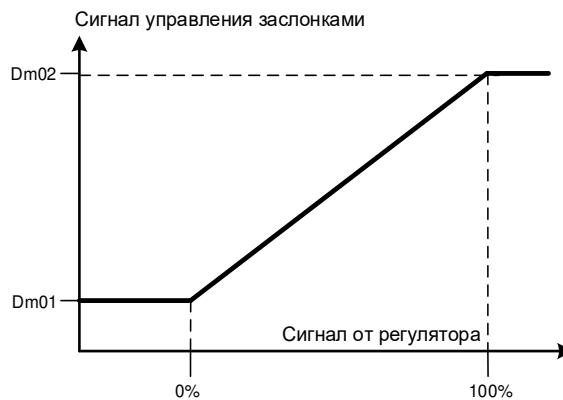
Следовательно, сигнал любого регулятора может быть преобразован в управляемое напряжение, изменяющееся в необходимом диапазоне. Выходной диапазон задается параметрами Dm01 и Dm02 в процентах, при этом 0 % соответствует минимальному выходному напряжению 0 в (или 2 в, в зависимости от конфигурации данного аналогового выхода), а 100 % - напряжению 10 в.
