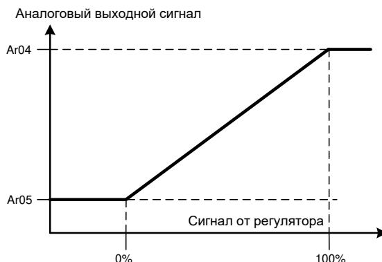
На основании выходного сигнала регулятора может быть сформирован цифровой сигнал, который может быть использован для управления одним из выходных реле контроллера. С помощью параметров Ar07 и Ar08 задаются условия включения и выключения реле:
