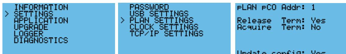
2. Войти в системное меню терминала (см. инструкцию для терминала) и установить адрес терминала 32, 31 или 30. Проверить, чтобы в меню конфигурирования терминалов напротив каждого из используемых терминалов был установлен атрибут Sh (общий). Если используется более одного терминала, то у всех терминалов должны быть разные адреса из указанного диапазона. Заводская установка адреса - 32.
