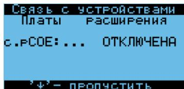
Первый этап конфигурирования контроллера – подключение плат расширения с.рСОЕ и рСОЕ.
