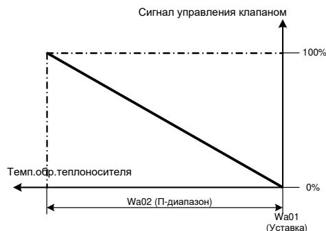
Если установка выключена и от стратегии режима установки получен сигнал активации процедур для холодного времени года, то температура теплоносителя, возвращаемого в сеть, поддерживается на заданном с помощью параметра Wa01 безопасном уровне. Регулирование температуры производится ПИ-регулятором. П-диапазон и время интегрирования регулятора заданы параметрами Wa02 и Wa03 соответственно.
