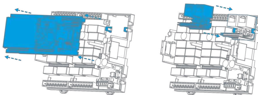
Рис. 65 – Снятие процессорной платы и установка платы сетевой карты
