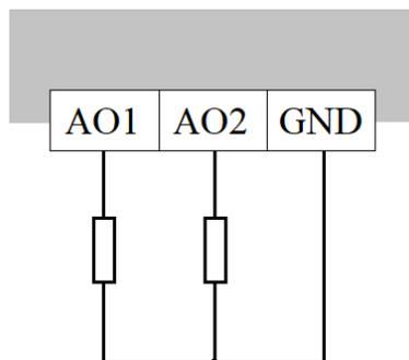
Аналоговые выходы могут быть использованы в качестве генератора ШИМ сигнала.
