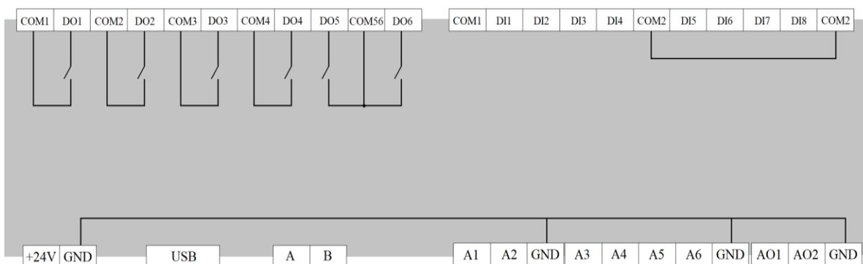
Контакты «GND» объединены между собой. При подключении датчиков через внешние клеммы контакт «GND» может быть соединен в одном месте.
