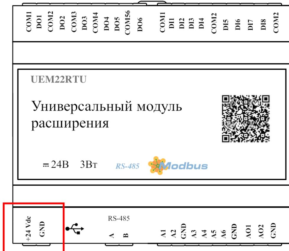
Источник питания должен быть постоянного тока с выходным напряжением 24 вольт и мощностью не менее 10 Вт.
