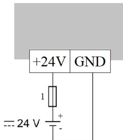
1 - Плавкий предохранитель типа Т на 2 А.
