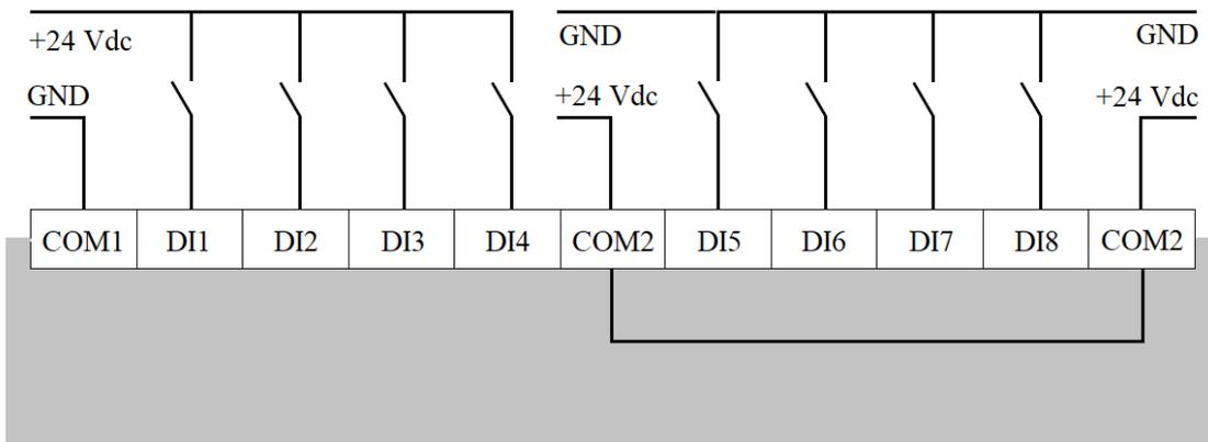
COM1 и COM2 между собой развязаны, что позволяет первые 4 дискретных входа подключить, например, по положительной логике, подключив на COM1 «GND», DI1 / DI2 / DI3 / DI4 – «+24Vdc», а оставшиеся 4 дискретных входа по отрицательной логике, подключив на COM2 «+24Vdc», DI5 / DI6 / DI7 / DI8 – «GND», как показано на рисунке выше.
