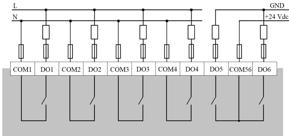
Дискретные выходы DO5 и DO6 – твердотельные реле без защиты от короткого замыкания с общим COM56, с номинальным напряжением **не более 24 вольт**. Могут использоваться для управления индикаторными лампами, промежуточными реле и контакторами с управляющим напряжением 24 вольта. В режиме ШИМ могут управлять производительностью электронагревателей через промежуточные силовые твердотельные реле.
